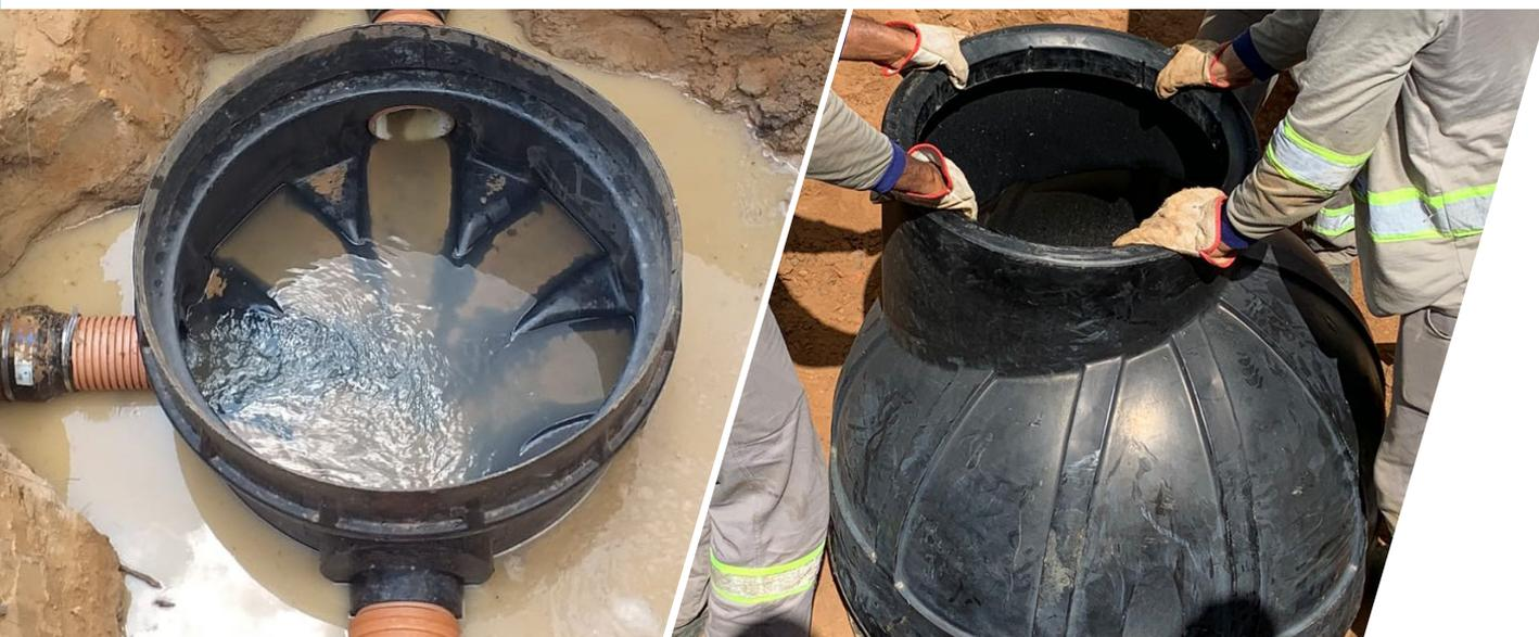
Les regards Ambidur fabriqués par le Groupe Politejo, selon le procédé de roto moulage conformément à la norme EN 13598-2, constituent la solution idéale pour les systèmes d'évacuation gravitaires, et sont principalement utilisés pour les eaux pluviales, les eaux usées domestiques et les rejets industriels.
